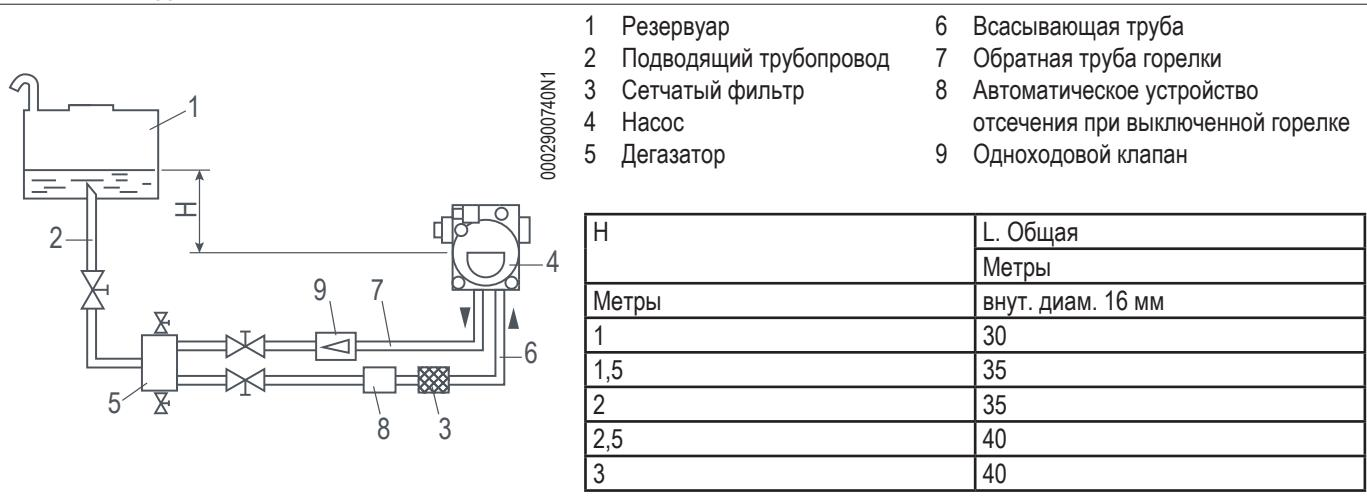
**СИСТЕМА ПОДАЧИ ТОПЛИВА САМОТЁКОМ ИЗ ВЕРХНЕЙ ЧАСТИ РЕЗЕРВУАРА**
